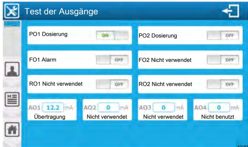
Abb. 124: Menü „Benutzer“ - „AUSGÄNGE TEST“ in beispielhafter Ausführung
