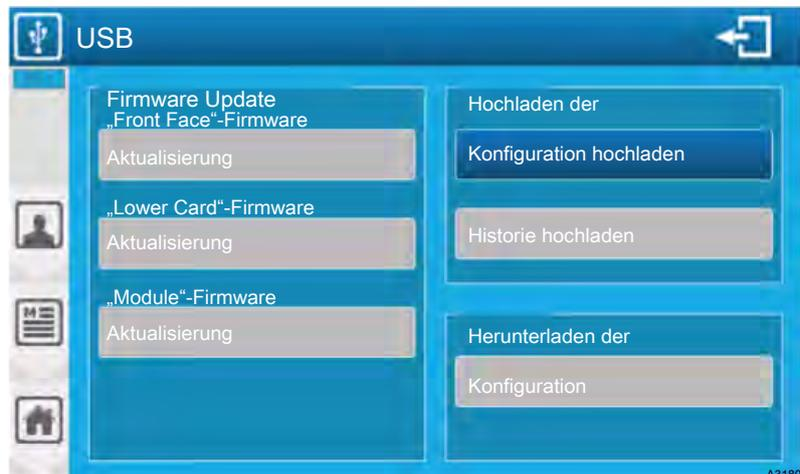
Abb. 121: Um auf dieses Menü (Programmierschirm) zuzugreifen, müssen Sie einen USB-Stick einstecken.
