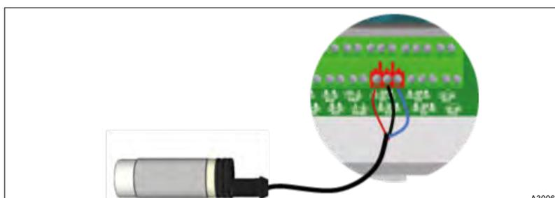
Abb. 15: Anschluss eines Strömungsschaltersensors am DI2
