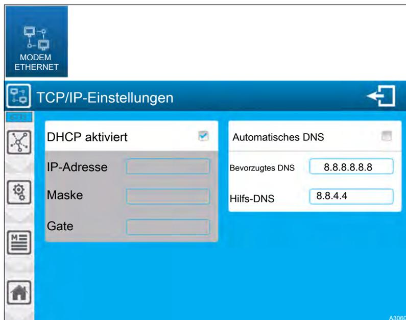
Abb. 64: Konfiguration des Ethernet-Modems [6731]
