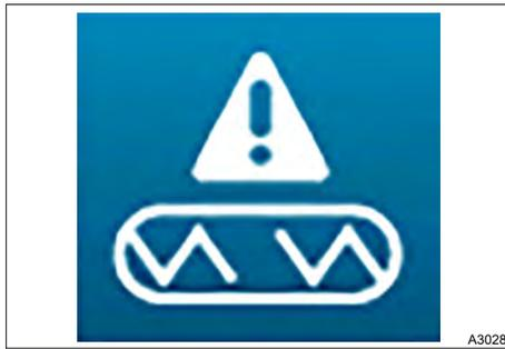
Die selbstversorgten PO1- und PO2-Relais haben eine TR5-Sicherung. Wenn eine Sicherung zerstört wird, erscheint ein spezielles Symbol (siehe nebenstehende Abbildung) auf dem betreffenden Ausgang.
