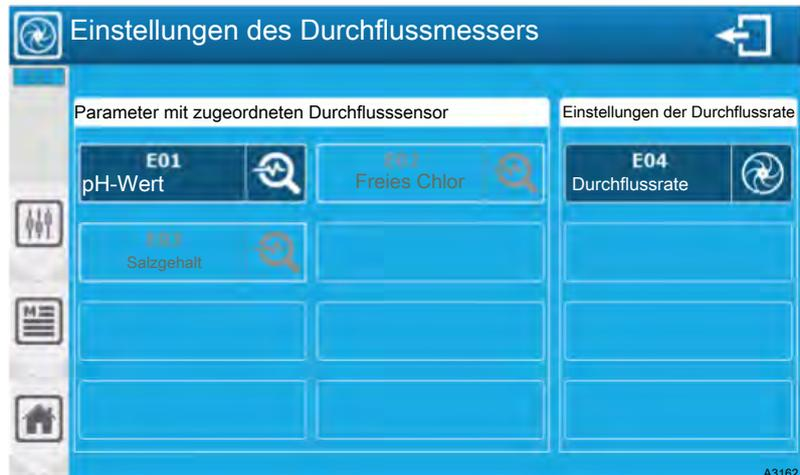
Abb. 108: Einstellungen des Durchflussmessers
