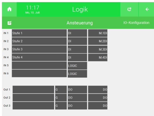
10. Drücken Sie auf die Schaltfläche rechts von "Out 1" und geben Sie einen Namen ein (bspw. Ansteuerung Meltem).
