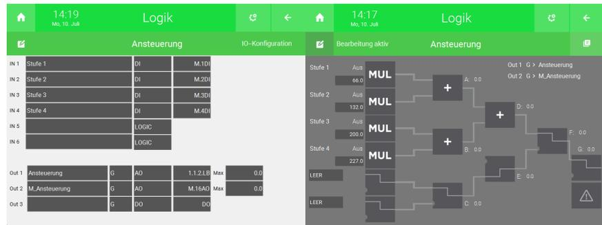
Die Merker für die verschiedenen Stufen werden mit dem Wert für die jeweilige Stufe multipliziert. Das Ergebnis wird dann in das Register geschrieben. Bei Auswahl der Stufe 4 wird der Wert 227 in das Register geschrieben (Intensivlüftung).
