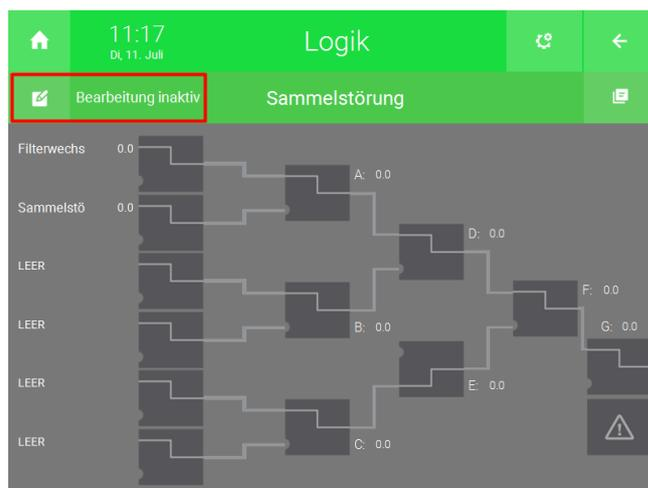
15. Drücken Sie auf das Gatter mit dem Ausgang "A" und wählen Sie "ALARM" aus.
